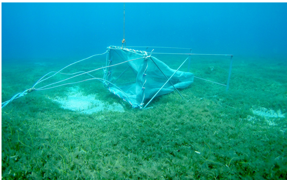
Figure 6 : chalut épibenthique utilisé pour l'étude de la petite faune vagile des herbiers à Halophila stipulacea .
