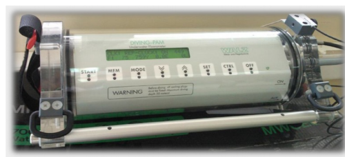
Figure 4 : Incubateur sous-marin « Diving PAR » de Waltz
