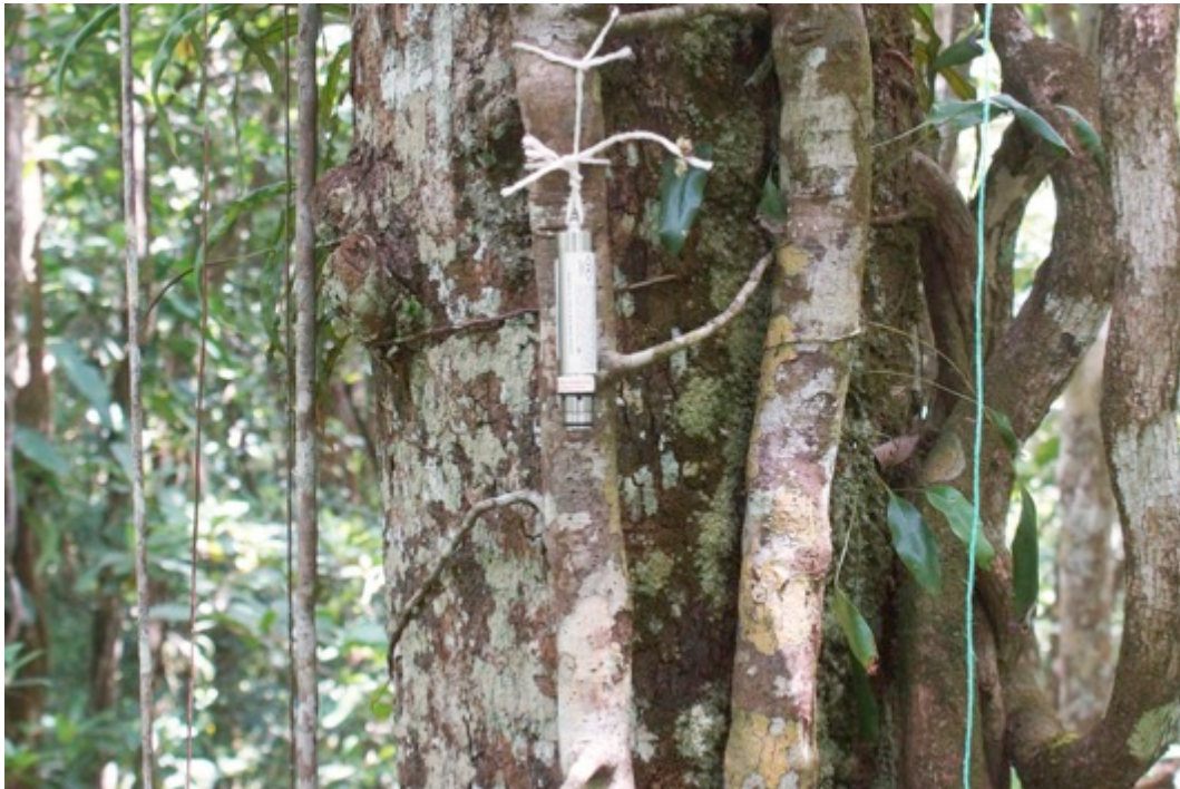
Figure 9. Capteur Madgetech RH Temp 1000 installé sur la placette de Bras David.
