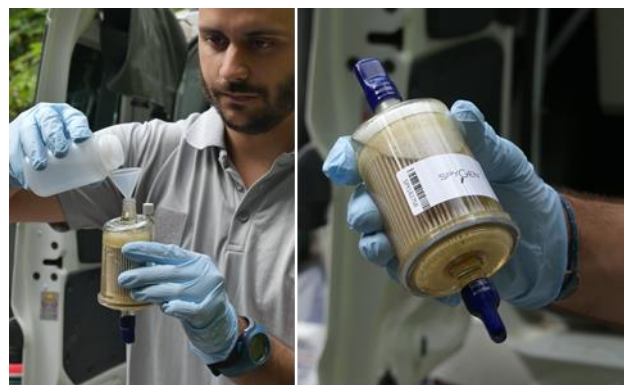
Figure 3 : Capsule de filtration remplie d'un tampon de conservation
