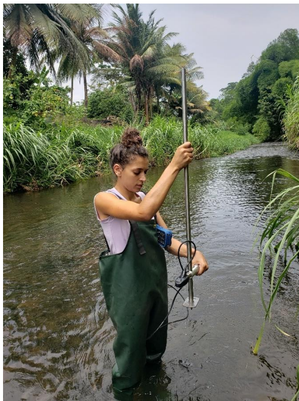
Figure 3 : Mesure avec le courantomètre, Crédit : Marie Robert
