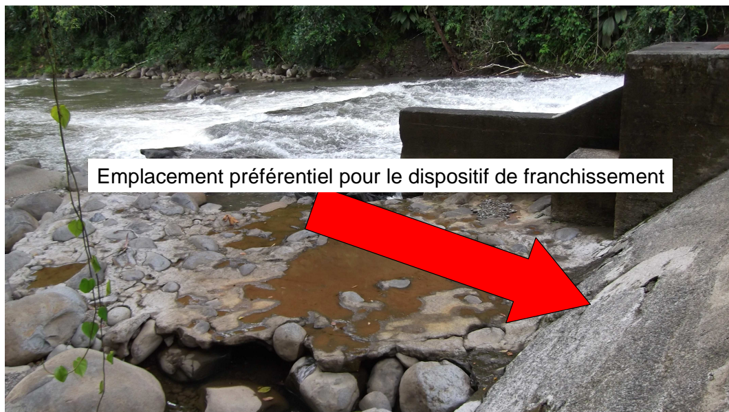
Figure 14 : Proposition d'emplacement du dispositif de franchissement
