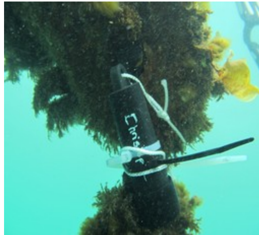
Illustration 12 : Thermographe situé sur une bouée de l'îlet Christophe © S.Mège
