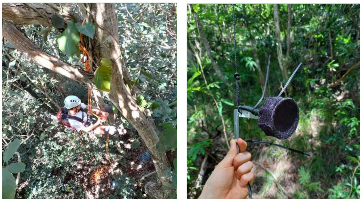
Figure 10 : Ascension pour l'installation des cordes fixes (gauche) et dispositif de protection des micros (droite)
